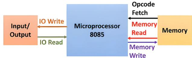
b) Interacción del Microprocesador con elementos externos a ella. Engineering Funda (s.f.b).
