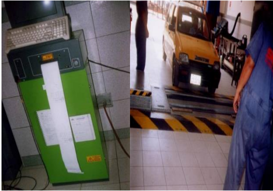
Figura 3: Dinamómetro de chasis Marca Bosh Modelo FLA 230 (izq.) Vista de rodillos del dinamómetro (der.).
