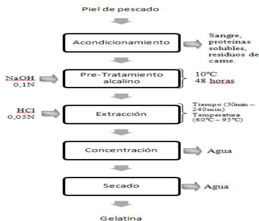
Figura 1: Diagrama de flujo del proceso de obtención de gelatina por extracción alcalina a partir de piel de tollo (Mustelus mento).
