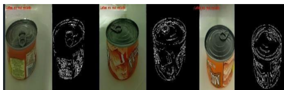
Figura 11. Detección exitosa de latas en mal estado
