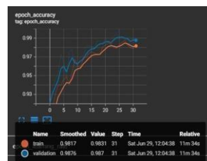
Figura 10. Resultados de Tensorboard del rendimiento de la red neuronal
