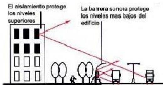
**Figura 9.** Forma de protección de una barrera voladiza.
