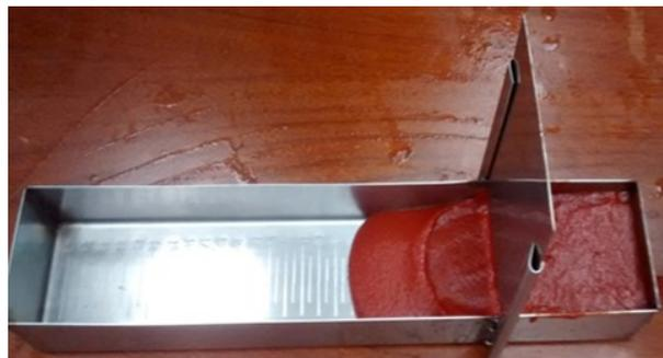
Figura 2. Consistómetro Bostwick diseñado.
