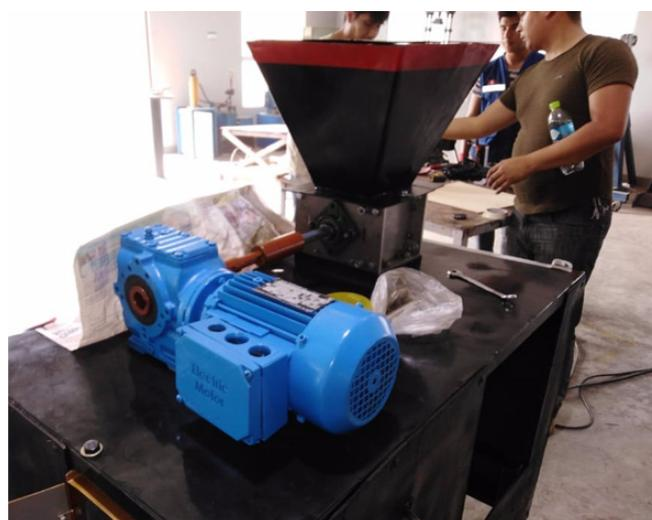
Figura 6. Motoreductor trifásico en conexión estrella usado en el proyecto.
