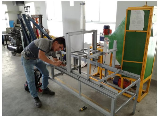
**Figura 2.** Estructura soporte de la máquina de cortar de arcilla húmeda para fabricación de ladrillo.
