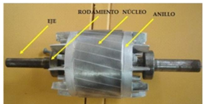
Figura 3: Partes principales del rotor de bobinado
