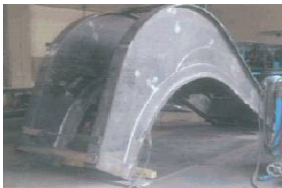
Figura 4. Cuello de Ganso en proceso de soldadura. Fuente: Elaboración Propia.
