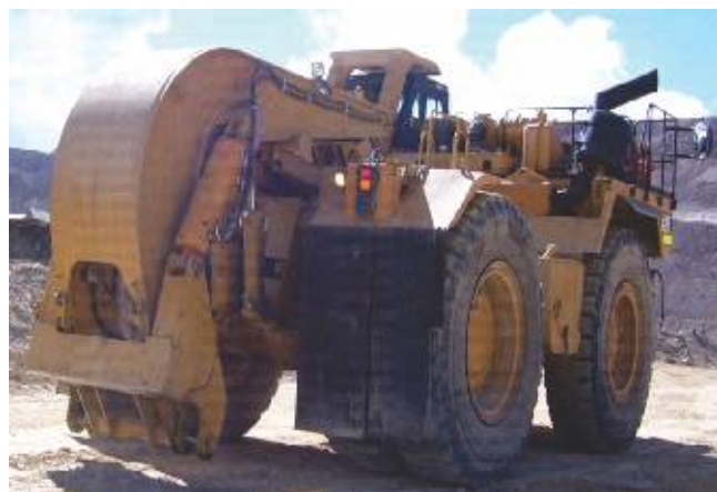
Figura 2. Cuello de ganso armado con el camión 777D. Fuente: Elaboración Propia.
