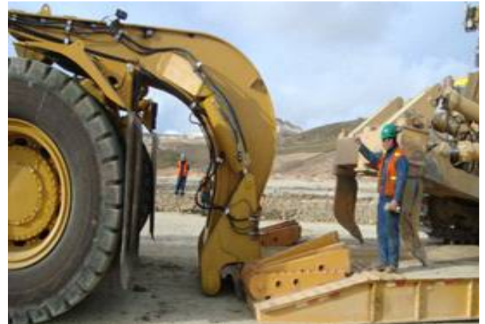
Figura 12. Ensamblaje del Cuello de Ganso a la cama baja. Fuente: Elaboración Propia.
