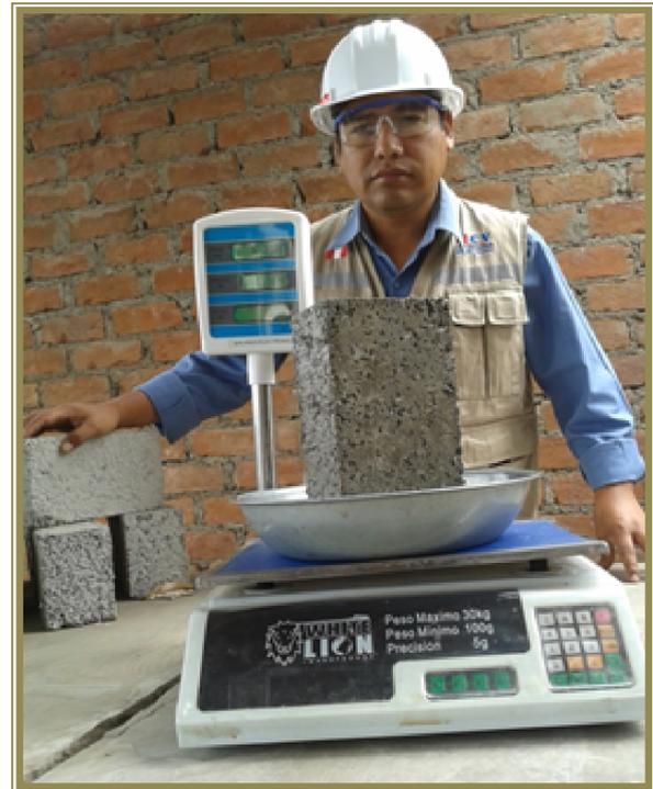
Figura 2. Medición de Porcentaje de absorción en ladrillos ecológicos.
