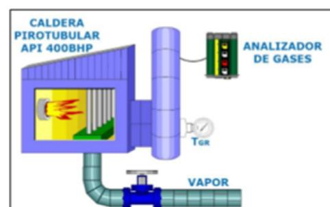
Figura 02: análisis de gases de chimenea al caldero pirotubular de 400 BHP.
