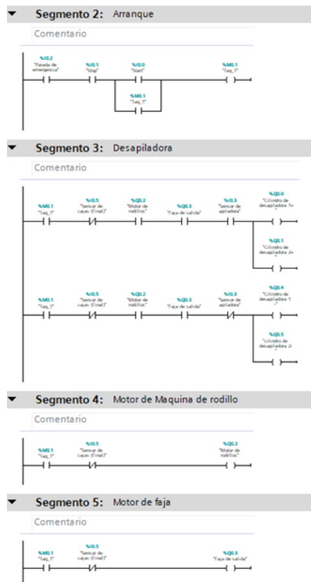
Figura 4. Algoritmo de programación en la PLC
