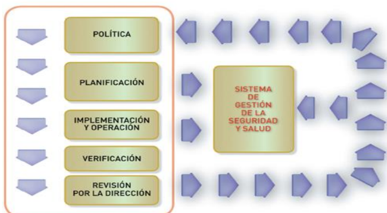
Figura N° 08: Elementos que componen la norma OHSAS 18001:2007
