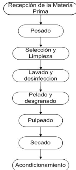
**Figura 1.** Diagrama de bloques del acondicionamiento de semilla de granadilla para la extracción de aceite por prensado en frío y solvente orgánico.
