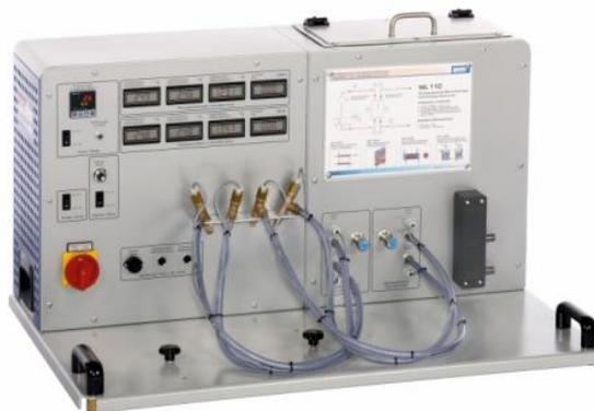
**Figura 4: Unidad de alimentación para intercambiadores de calor**
